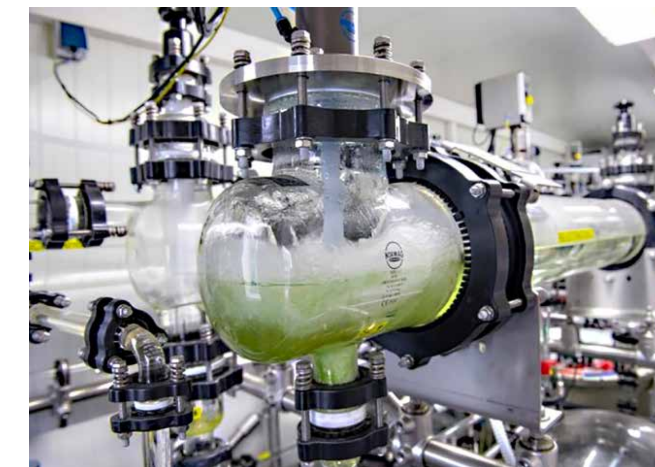
Flüssig-Flüssig-Extraktion des gelaugten Haldenmaterials im Wertstoffmodul der ReMining Plus - Pilotanlage (Helmholtz-Institut Freiberg für Ressourcentechnologie)
