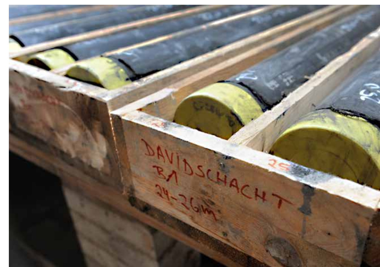
Bohrkerne aus der Spülhalde Davidschacht (G.E.O.S. Ingenieurgesellschaft mbH)
